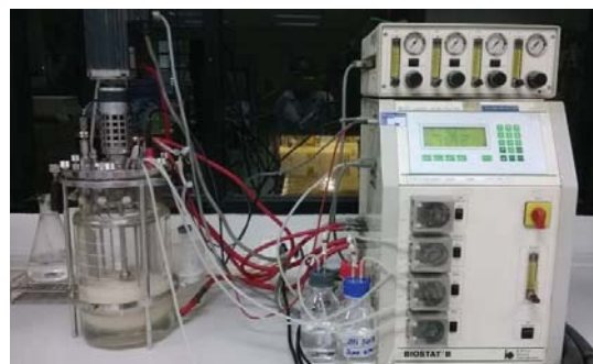
ภาพที่ 2 การเพาะเลี้ยงแบคทีเรีย C. necator DSM 545 เพื่อผลิตพีเอชบีโดยใช้ไฮโดรไลเสตลำต้นปาล์มเป็นแหล่งคาร์บอนในถังหมักขนาด 5 ลิตร
