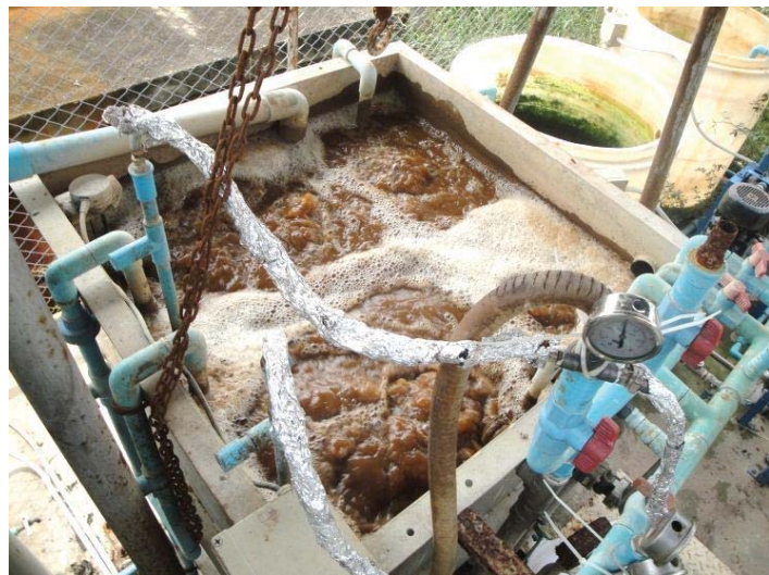
ภาพที่ 2 ถังปฏิกรณ์ชีวภาพเมมเบรนในห้องปฏิบัติการ (ซ้าย) และ ถังปฏิกรณ์ชีวภาพเมมเบรนระดับทดลอง ที่ติดตั้ง ณ พื้นที่กำจัดมูลฝอย (ขวา)
