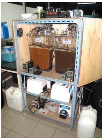
ภาพที่ 2 ถังปฏิกรณ์ชีวภาพเมมเบรนในห้องปฏิบัติการ (ซ้าย) และ ถังปฏิกรณ์ชีวภาพเมมเบรนระดับทดลอง ที่ติดตั้ง ณ พื้นที่กำจัดมูลฝอย (ขวา)
