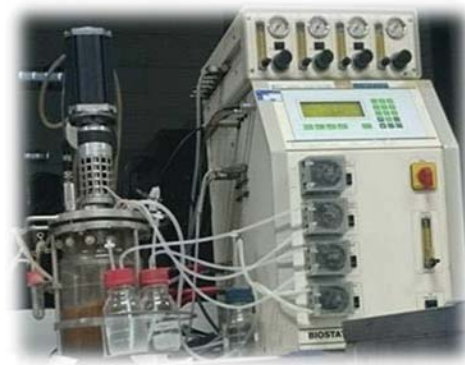
ภาพที่ 1 การเพาะเลี้ยงแบคทีเรีย B. licheniformis ATCC 9945 ด้วยกากผงชูรส (อามิอามิ) ในถังหมักขนาด 2 ลิตร เพื่อผลิตพอลิแกมมาไกลูตามิกแอซิด
