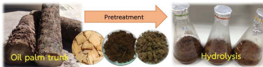
ภาพที่ 1 การพรีทรีตเมนต์และการย่อยลำต้นปาล์มเพื่อเตรียมไฮโดรไลเสตลำต้นปาล์ม
