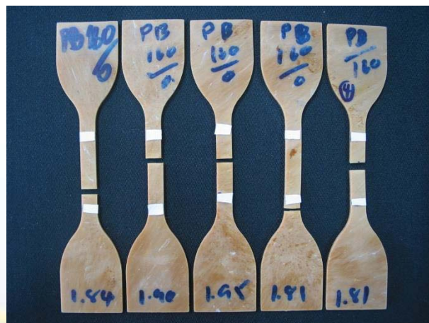
ภาพที่ 106-2 ชิ้นทดสอบรูปดัมเบลล์สำหรับสมบัติแรงดึง
