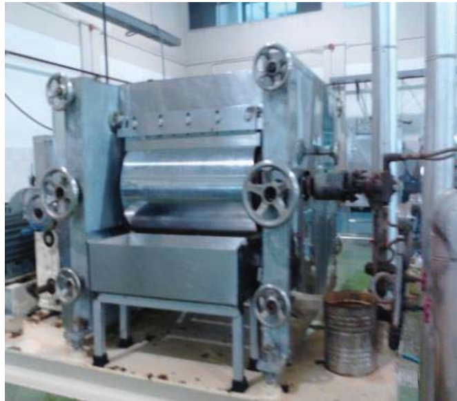
ภาพที่ 37-1 เครื่องอบแห้งแบบลูกกลิ้งทรงกระบอก
