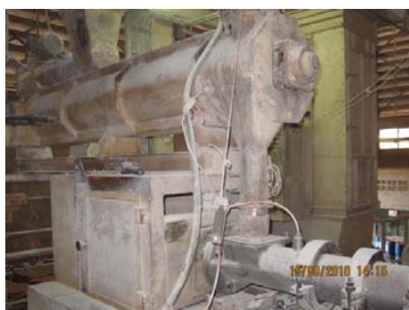
ภาพที่ 103-1 เครื่องเอกซ์ทрудที่ใช้ในการผลิต
