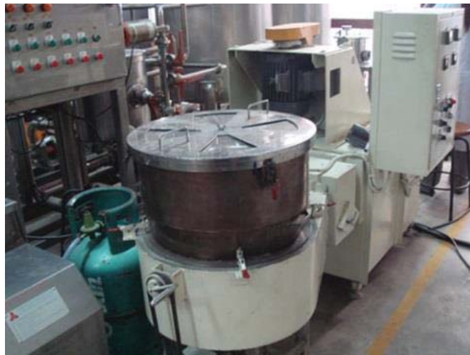
ภาพที่ 12-1 เครื่องอบแห้งแบบฟลูอิดไชน์เบต
