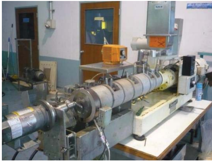
ภาพที่ 60-1 เครื่องเอกซ์ทรูเดอร์แบบสกรูคู่
