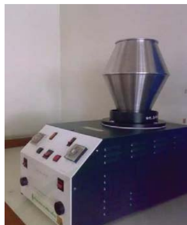
ภาพที่ 11-2 เครื่องอบแห้งแบบฟลูอิดซ์เบตระดับห้องปฏิบัติการ
