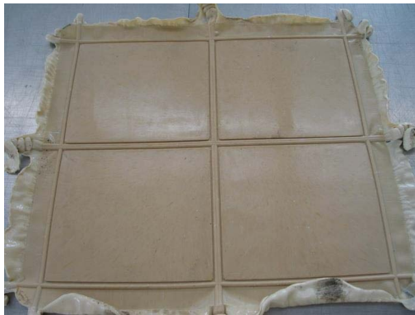
ภาพที่ 106-1 แผ่นยางวัลคาไนซ์ที่ได้จากกระบวนการผสม สำหรับนำไปทดสอบสมบัติเชิงกล
