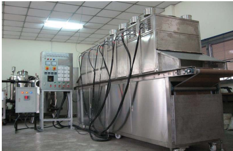
ภาพที่ 40-1 เตาไมโครเวฟแบบสายพานไหลต่อเนื่อง
