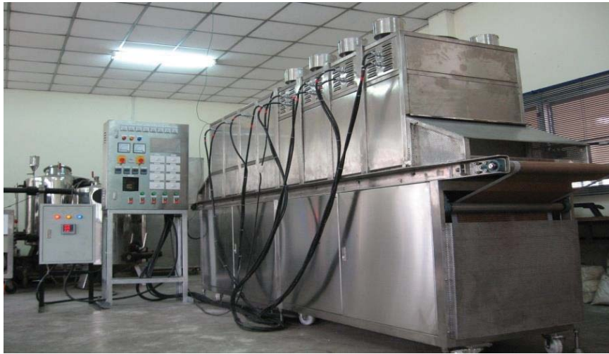
ภาพที่ 39-1 เครื่องไมโครเวฟแบบสายพานไหลต่อเนื่อง
