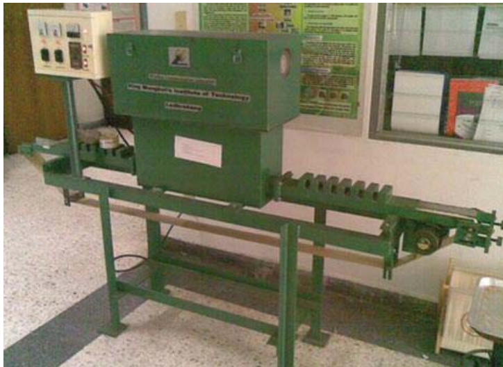
ภาพที่ 14-1 เครื่องไมโครเวฟแบบสายพานไหลต่อเนื่อง
