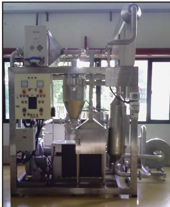
ภาพที่ 13-1 เครื่องอบแห้งแบบฟลูอิดไคซ์เบดร่วมกับป้อนความร้อนที่ออกแบบโดยคณะวิจัย
