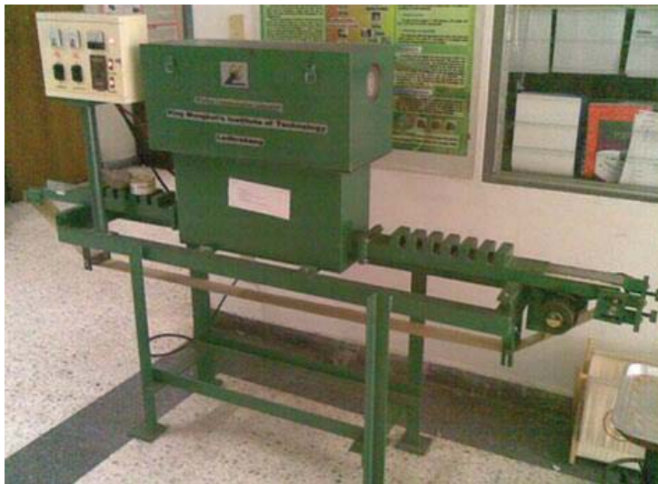
ภาพที่ 32-1 เครื่องไมโครเวฟแบบสายพานไหลต่อเนื่อง
