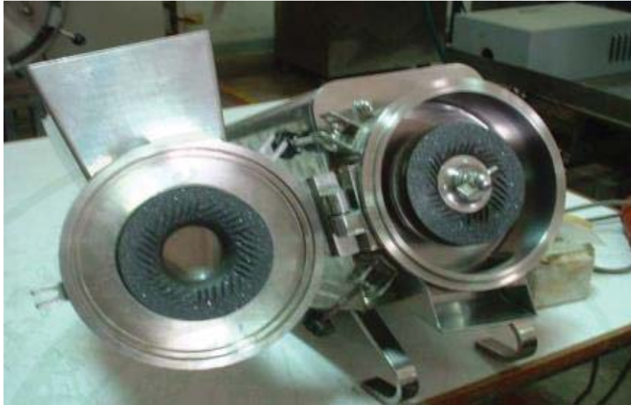
ภาพที่ 50-1 เครื่อง super mass colloid ที่ใช้บดเปียก
