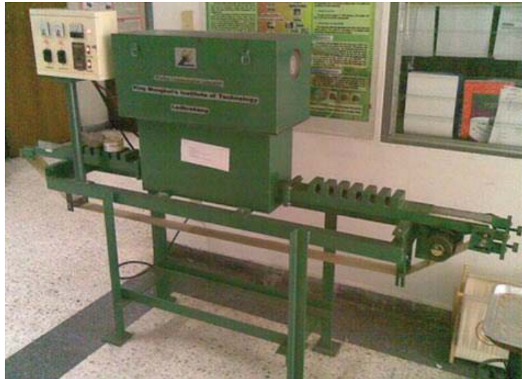
ภาพที่ 53-1 เครื่องไมโครเวฟแบบสายพานไหลต่อเนื่อง
