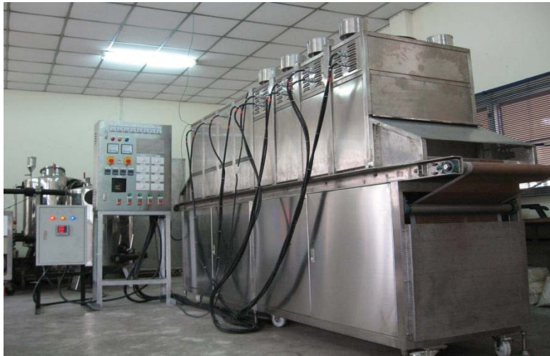
ภาพที่ 35-1 เตาไมโครเวฟแบบสายพานไหลต่อเนื่อง
