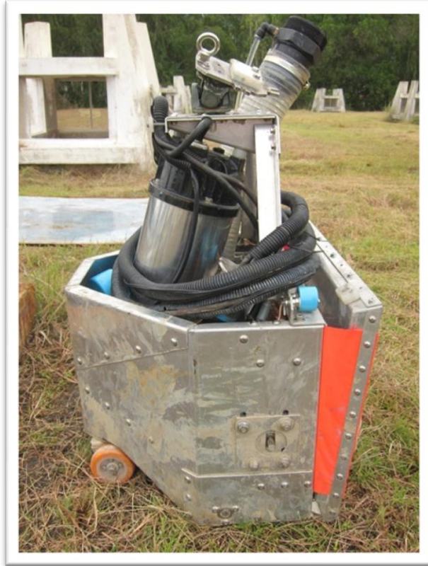
รูปที่ 10 หุ่นยนต์ทำความสะอาดถึงน้ำใสส่วนปฏิบัติงานใต้น้ำ
