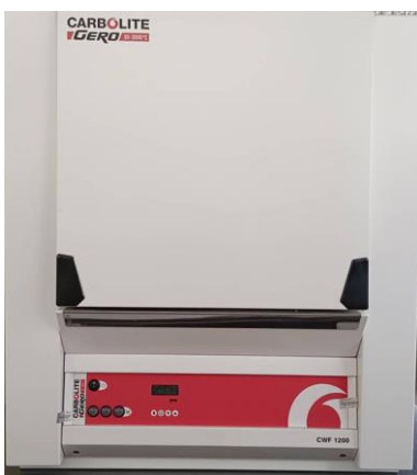
เตาเผาอุณหภูมิสูงยี่ห้อ CARBOLITE รุ่น CWF12/65 อุณหภูมิสูงสุด 1,200 องศาเซลเซียส
