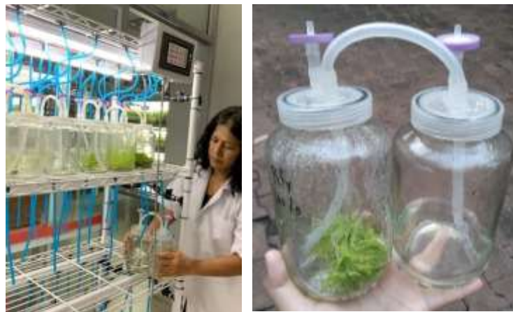
Figure 3 การเพาะเลี้ยงเนื้อเยื่อไม้ต่าง Philodendron spp. (กึ่งต่าง) ด้วยระบบ TIB เป็นระยะเวลา 30 วัน
