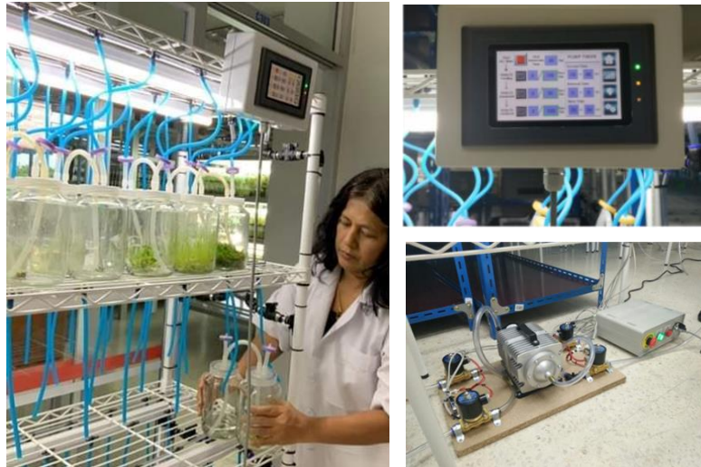
Figure 2 ชุดไบโอรีแอกเตอร์จุ่มชั่วคราวแบบขวดแผลด ณ ห้องปฏิบัติการเพาะเลี้ยงเนื้อเยื่อ ฝ่ายเครื่องมือและวิจัยทางวิทยาศาสตร์ มหาวิทยาลัยเกษตรศาสตร์ ได้นำมาทดลองใช้ในการศึกษาวิจัยพืชต่างๆ
