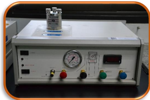
ภาพที่ 2 เครื่อง Critical Point Dryer (Quorum; K 850)
