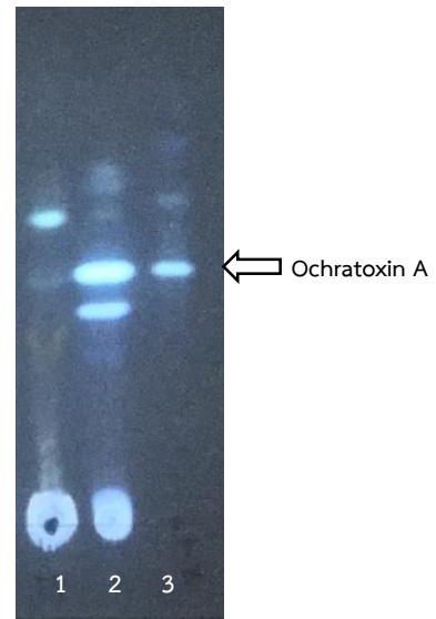
ภาพที่ 1 การตรวจสอบสารออกคราทอกซินบนแผ่น TLC ด้วยแสง UV 366 นาโนเมตร
