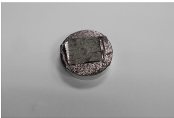
ภาพที่ 3 ชิ้นเนื้อไม้ที่ติดอยู่บนแท่นวางตัวอย่างและผ่านการเคลือบโลหะเรียบร้อยแล้ว
