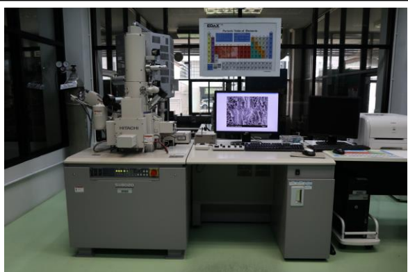
ภาพที่ 4 ศึกษาลักษณะโครงสร้างทางกายวิภาคของเนื้อไม้ด้วยกล้องจุลทรรศน์อิเล็กตรอนแบบส่องกราด (Hitachi: SU8020)
