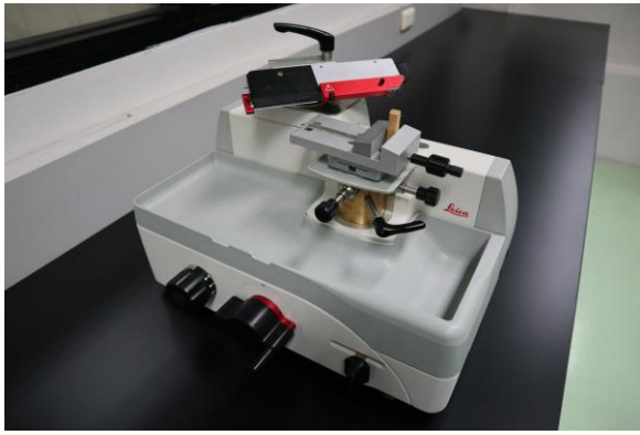
ภาพที่ 1 เครื่อง Sliding Microtome (Leica: SM20108)
